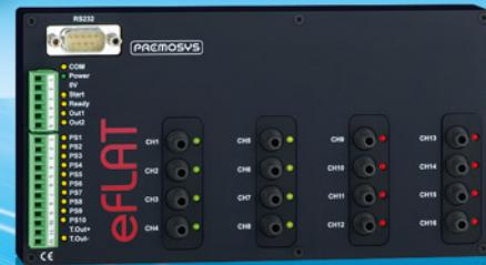
Mit dem System können durch 4 Produktvarianten von 4 bis zu 16 LEDs parallel getestet werden. Farbe und Intensität können unabhängig voneinander für jeden Messkanal parametriert werden. eFLAT lässt sich durch Kalibrierfunktionen auf hohe absolute Genauigkeiten trimmen. Ebenso kann der Kunde Kalibrierungen mit eigenem Messequipment durchführen und somit die absolute Genauigkeit weiter steigern.
