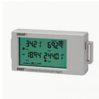
El UX120-014M es un registrador de temperatura en ambientes interiores para sensores de termopar. Proporciona una flexibilidad excepcional al aceptar sondas termopares tipo J, K, T, E, R, S, B o N, ideales para el registro de temperaturas elevadas.
