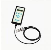
Gracias al sensor de suelo del Hydra Data Reader tendrá la temperatura, humedad y la conductividad eléctrica. Los datos pueden ser visualizados en el momento y ser almacenados por el usuario. El lector puede descargar los datos en una PC para ser archivados, presentar gráficos y generar informes. Con una carcasa resistente, compacta y ligera, usted podrá trabajar en ambientes con condiciones severas. El sensor portátil más eficiente y preciso.
